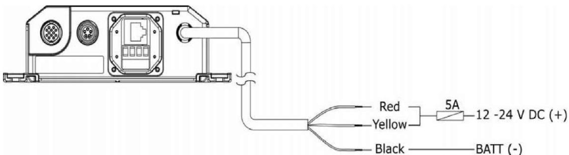
Для систем, не использующих радиолокационный интерфейсный блок (Lowrance HDS, продаваемый только в США) :
