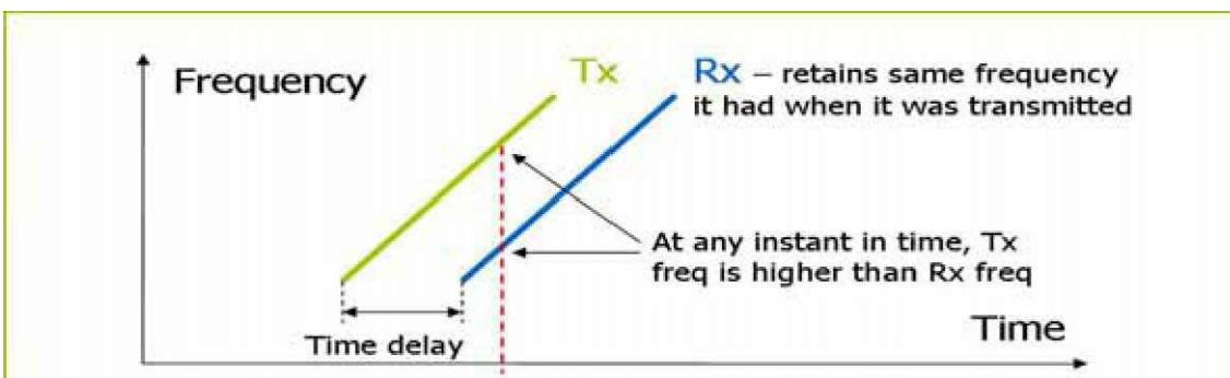
Разница между только что переданной частотой и частотой принятой, вместе с известным уровнем увеличения частоты, позволяет вычислить время прохождения волны.
